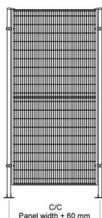
Das Smart Fix System besteht einen Stabilitätstest mit 1600 Joule in Verbindung mit den Pfosten 60x40 mm und den Gitterelementen ST20 und ST30.
