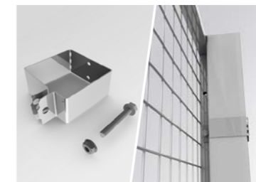
8 KLAMMER 80x80 Die Pfosten werden hinter den Elementen montiert. Die Elemente lassen sich dann sehr einfach mit den Halteklammern verschrauben.
